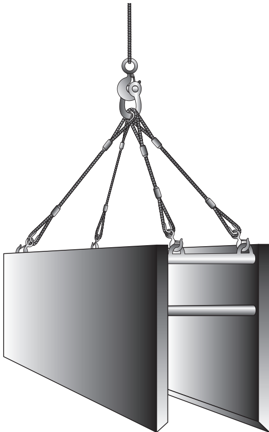
Étançonnement en acier
