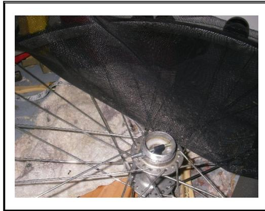
10. Percer chaque extrémité de la courroie de nylon (F), la mouiller et l'installer sur la jante de la roue de vélo. Pour maintenir la courroie en place, insérer l'attache autobloquante en nylon (Ty-Rap), longue de 20 cm (8 po), dans les trous de la courroie et serrer le montage à fond.
