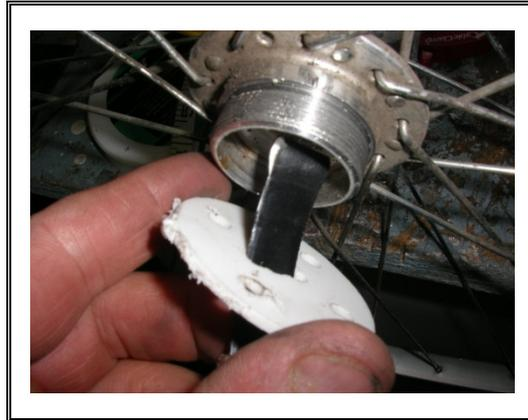
6. À travers le trou dans le moyeu de la roue, passer l'anneau du ruban à mesurer et insérer le boulon, la rondelle de blocage ainsi que l'écrou. Par la suite, serrer le montage à fond.
