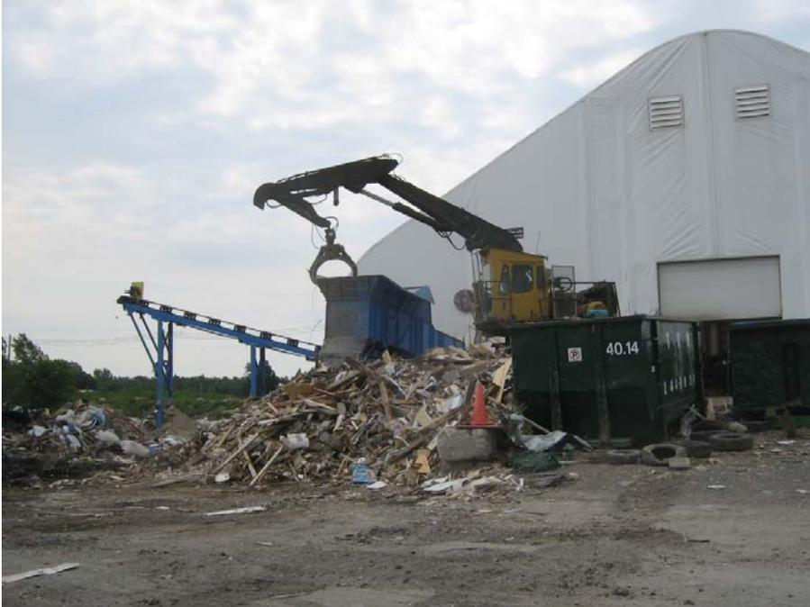
Figure 2 : Chargement des débris de CRD sur la table d'alimentation
