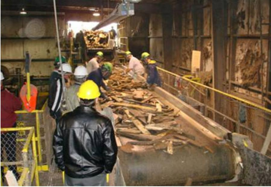
Figure 3 : Table de tri manuel dans un centre de tri de la Nouvelle-Angleterre
