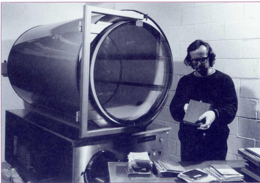
Cet appareil, le lyophilisateur, permet de sécher à froid et sous vide des documents abîmés par l'eau et sert également à stériliser les documents attaqués par des micro-organismes ou des insectes.
