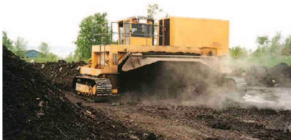
Photos : Ville de Laval. Exemple de compostage en andains extérieurs sur aire ouverte avec retournements mécaniques (retourneur d'andains)
