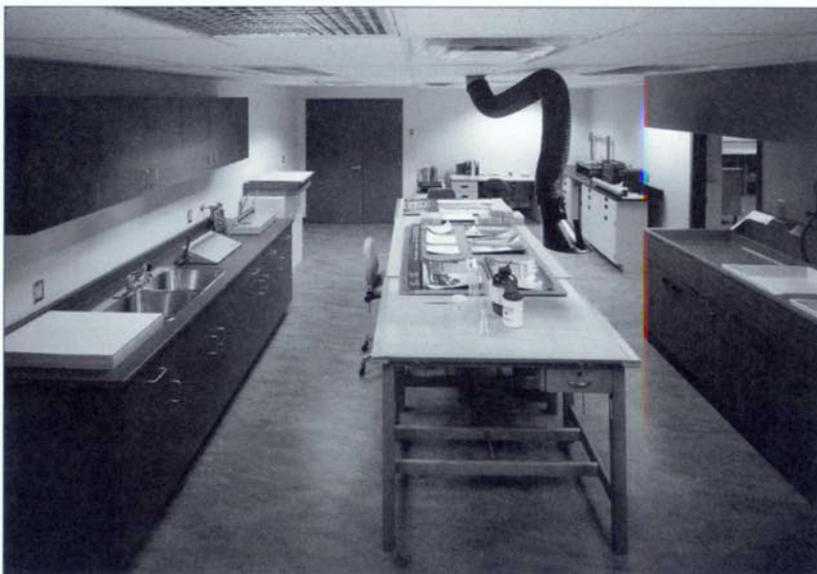
Vue de la salle de travail de restauration permettant de procéder au nettoyage par lavage, blanchiment et désacidification au carbonate de magnésium.
