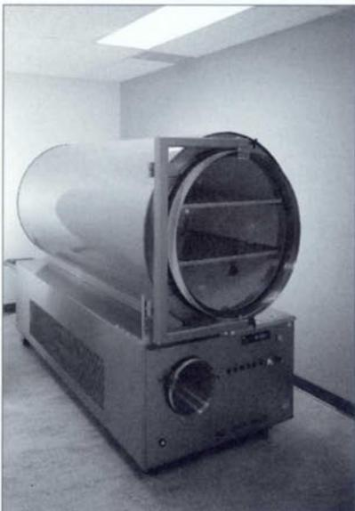
En cas de risque de propagation bactériologique ou de présence d'insectes, le document est placé dans le lyophilisateur afin d'être séché à froid.
