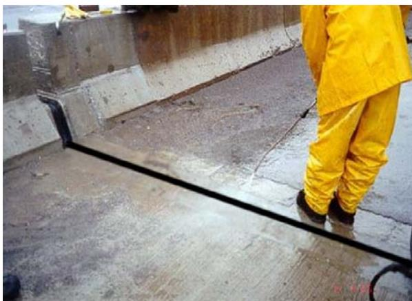
11. Essai d'étanchéité d'un joint de tablier
