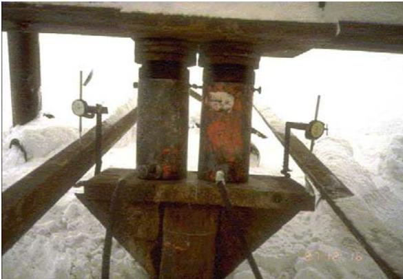
21. Essai de chargement : manomètres, vérins et extensomètres
