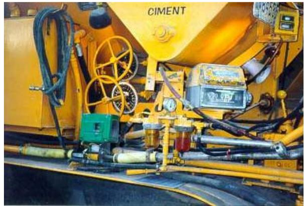
22. Détail des contrôles d'une bétonnière mobile
