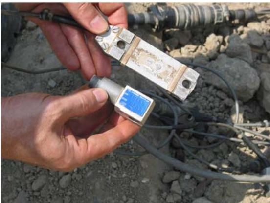
17. Essai dynamique : jauge de déformation et accéléromètre
