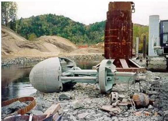
9. Clapet pour excaver l'intérieur d'un pieu caisson
