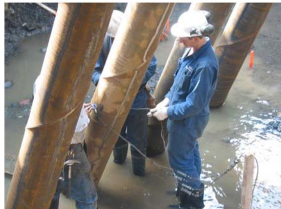
16. Instrumentation d'un pieu pour l'essai dynamique
