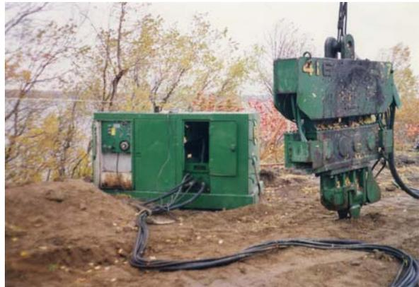
10. Vibrofonneur utilisé pour le fonçage des palplanches métalliques
