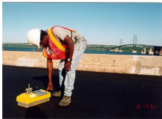
10. Mesure de la compacité au nucléodensimètre
