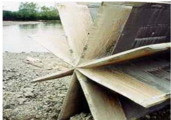
10. Trépan pour la réalisation de l'emboîture
