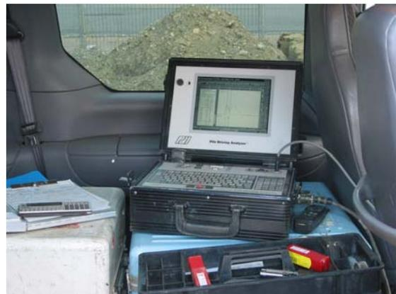
18. Essai dynamique : analyseur de battage
