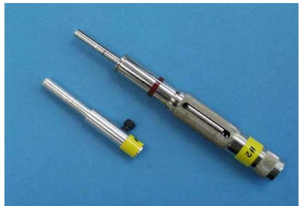
6. Pénétromètre à aiguille
