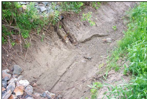
Figure 21 : Effets érosifs de l'eau sortant d'un drain agricole au mètre 140 du site n° 2 (8 juin 2005)
