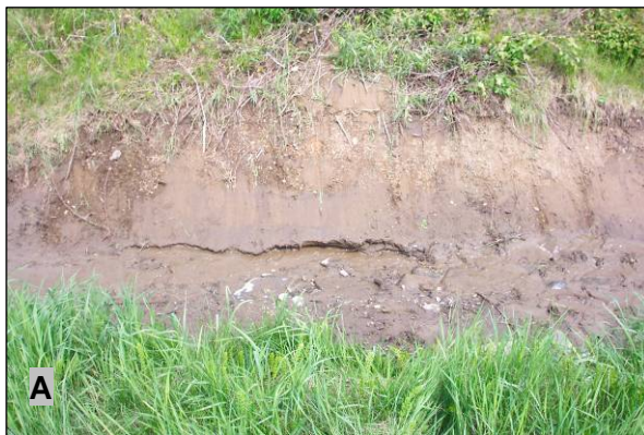
Figure 55 : Érosion rapide au mètre 9 du site n° 10 au cours de la journée du nettoyage du fossé (30 mai 2005) : A) photographie prise à 11 h 50; B) photographie prise à 15 h 55
