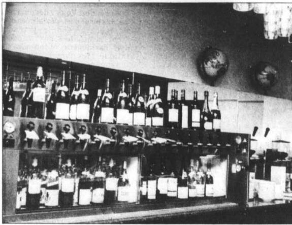
Seize bouteilles sont enfermées dans le « cruvinet », un appareil qui remplace l'air dans la bouteille entamée par une quantité égale d'azote, empêchant ainsi l'oxydation du vin.
