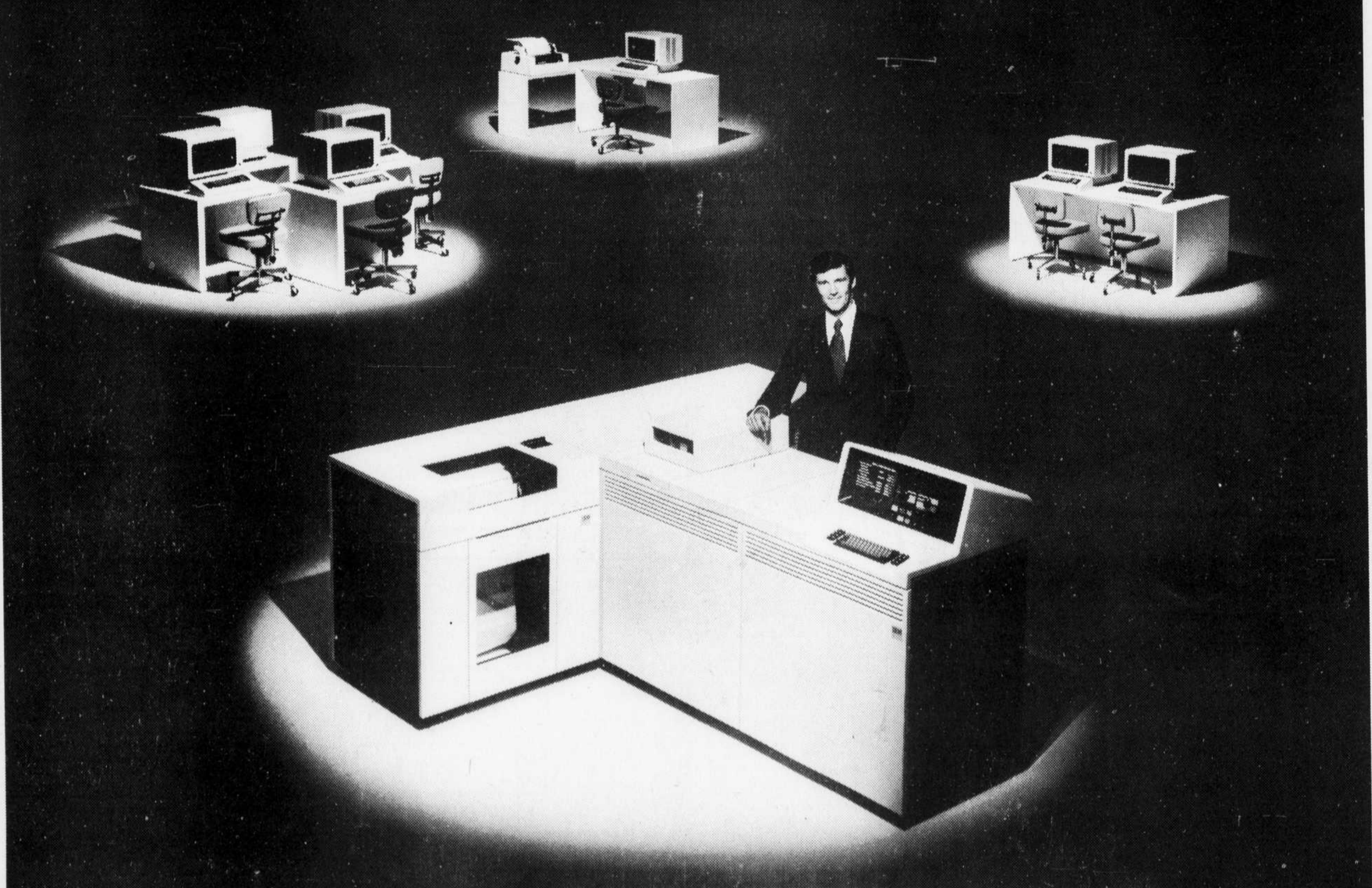
L'unité centrale de l'ordinateur IBM/38 avec une imprimante dont la vitesse peut atteindre 300 lignes à la minute et une unité de disques additionnelle pour une plus grande capacité de mémoire. La taille de la mémoire centrale varie entre 512K et 1 536K octets. En arrière-plan, trois configurations types de postes de travail.
