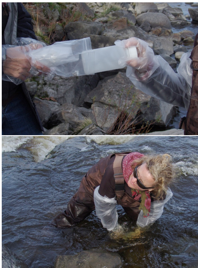
Figure 12 L'échantillonnage pour l'analyse des métaux exige des précautions spéciales pour éviter toute contamination
