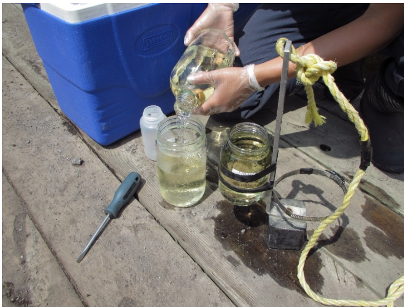
Figure 14 Transfert d'un échantillon pour l'analyse des pesticides dans une bouteille contenant un agent de conservation
