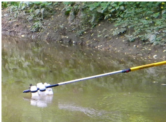
Figure 2 Perche télescopique utilisée pour l'échantillonnage à partir de la rive
