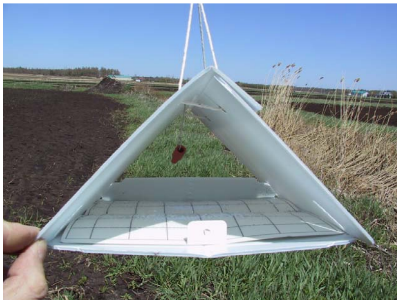
Photo 2 : piège Delta I : détail de l'intérieur du piège; notez que le rabat à l'avant du piège doit normalement être relevé comme celui du fond de manière à maintenir la plaquette engluée (carrelée en noir) bien en place.
