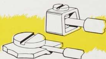
Nouveaux connecteurs éliminant le pliage des fils.
