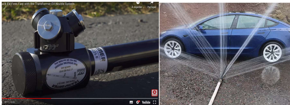
Figure 13. Des têtes de lances adaptées pour diriger le jet sous le véhicule
