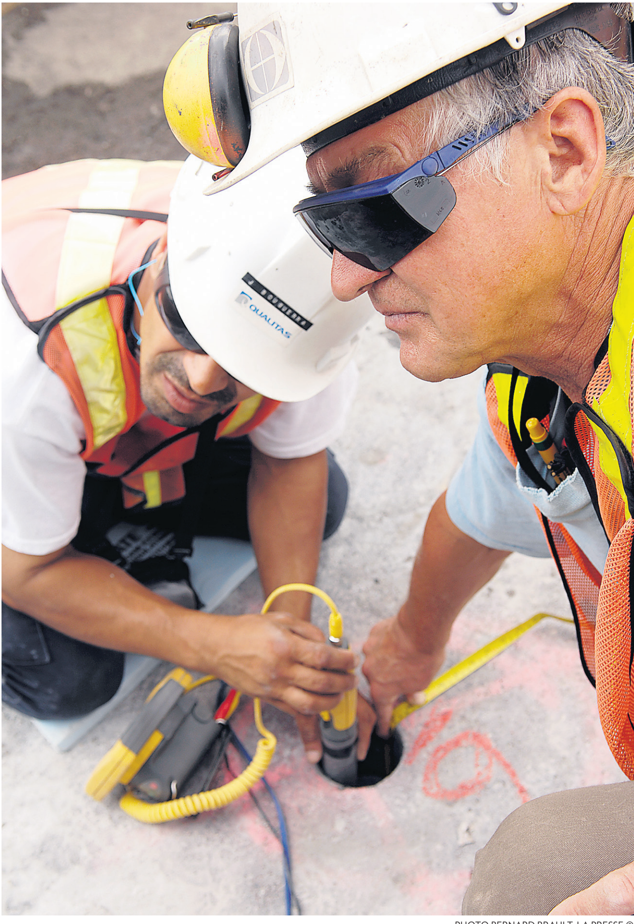
Des inspecteurs prélèvent des échantillons (carottes) de béton dans le viaduc de l'autoroute 30 à Sorel-Tracy. PHOTO BERNARD BRAULT, LA PRESSE ©
