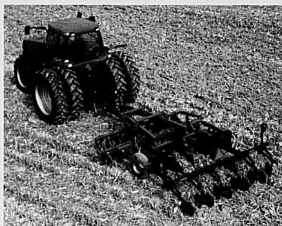
Écolo-tiger 527B. 5 dents à écartement de 27 à 30 po. Puissance nécessaire: 140 à 180 CV.
