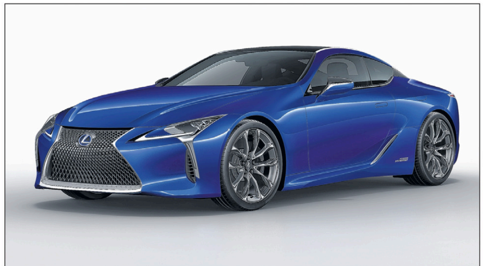
Lexus a dévoilé une version hybride de son coupé LC 500. La motorisation de la LC 500h combine un V6 de 3,5 l et un moteur électrique. La puissance totale atteint 354 ch.
