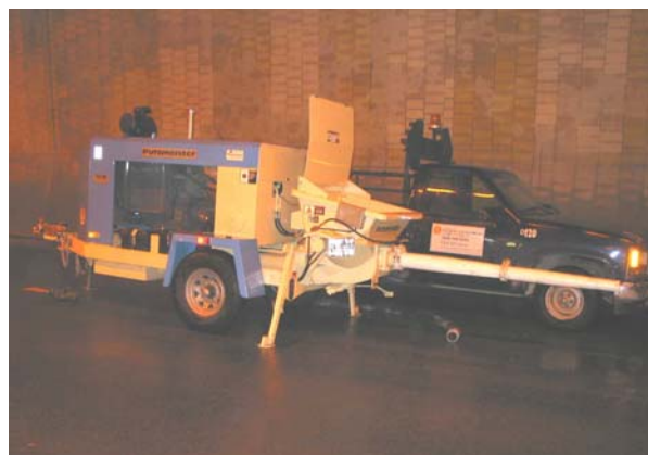
20. Pompe à béton remorquée
