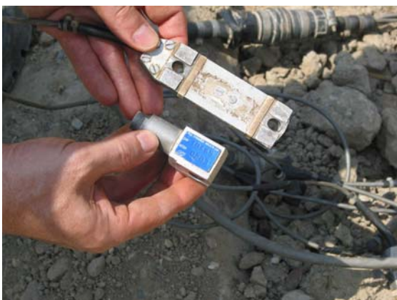
17. Essai dynamique : Jauge de déformation et accéléromètre
