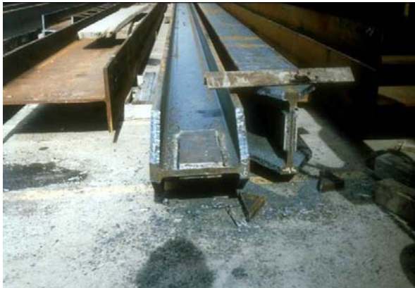
1. Pieux en H
