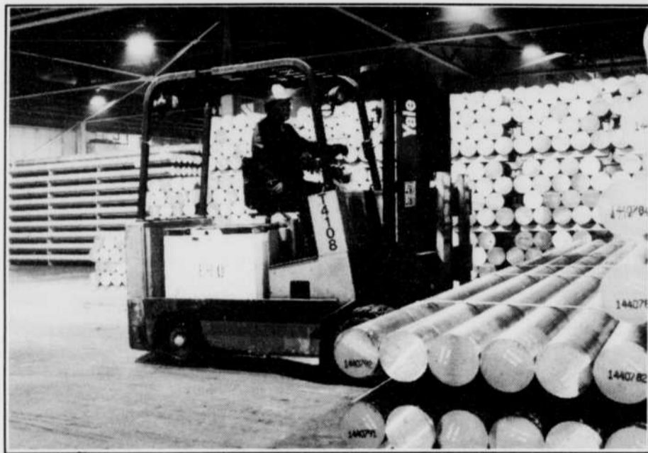
À gauche, des lingots de filage, appelés communément billettes, fabriqués au centre de coulée 5 de l'Usine Arvida et livrés à chaque semaine à Indalex. Roger Paradis, expéditeur, prépare un chargement de billettes. À droite, des lingots de tréfilage, fabriqués au centre de coulée 2, comme ceux qui sont envoyés chez Alcan Cable Williamsport. Almas Savard, préposé à l'expédition, attache ensemble les lingots pour livraison future.
