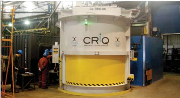
Enceinte de protection contre l'éclatement de pneus
