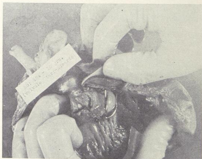
Fig. 8 — Prothèse mitrale montrant un caillot entre la colorette de Silastic et l'anneau mitral en Teflon.
