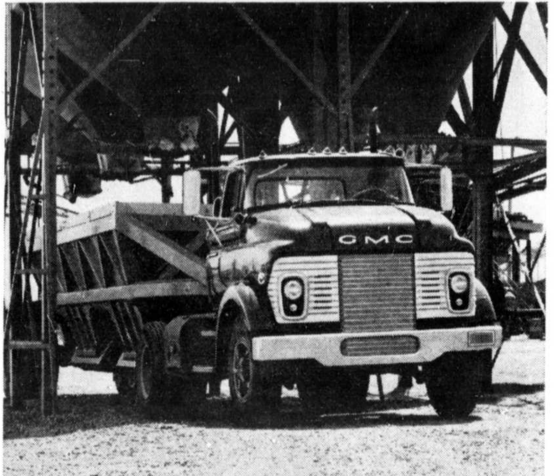
Le tracteur diesel poids lourd GMC 6-71 de 1963 est un des modèles diesels désormais construits au Canada par General Motors. GMC présente aussi des moteurs six cylindres à essence de poids réduit, développant 140 et 165 CV; un quatre-cylindres de 90 CV; une suspension avant à ressorts à boudin sur les modèles poids léger à cabine normale, ainsi que des ressorts arrière à boudin, à double effet, sur les modèles d'une demi-tonne et de ¾ de tonne et des essieux avant à poutre en I avec ressorts à lames à flexibilité variable sur les séries poids moyen et poids lourd.
