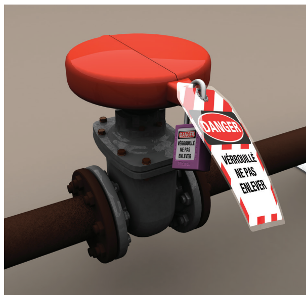
Isolation d'un circuit de vapeur
