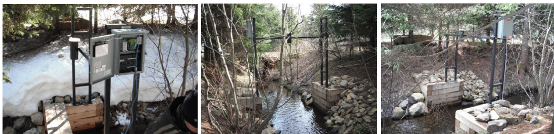
Photos 8, 9 et 10. Station ultra-sons d'enregistrement en continu des débits entrants (Photos n os 8, 9 et 10, Groupe AIM inc.)
