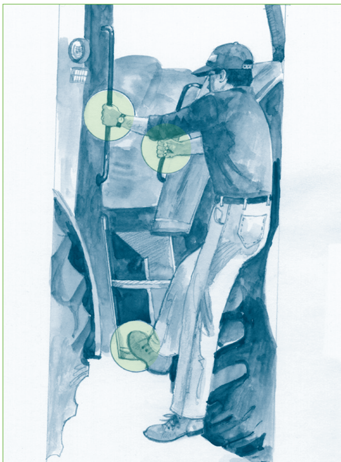
Application de la technique des trois points d'appui pour descendre du tracteur
