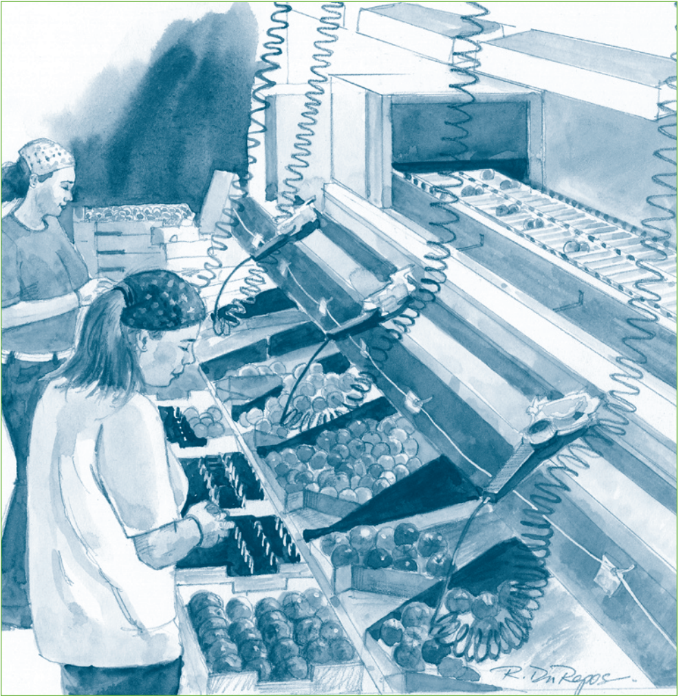
Poste de tri où s'effectue un premier triage automatisé et aménagement permettant le travail à l'intérieur de la zone d'atteinte
