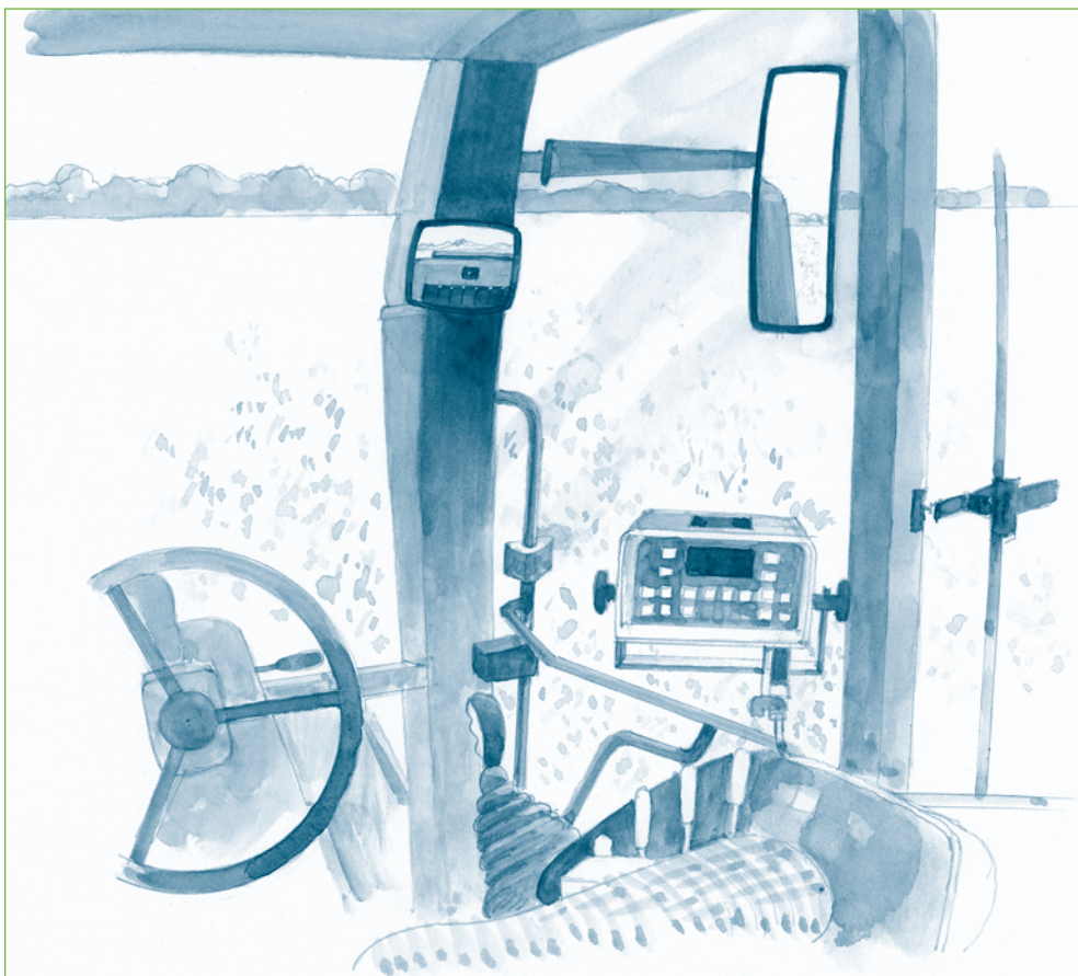
Aménagement d'une cabine de tracteur pour limiter les mouvements de torsion du dos
