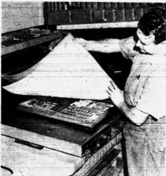
Autre opération de la "mise en marche" d'un journal : la prise de "matrices" qui permettra de couler les cylindres de métal pour l'impression. Au travail : Didier Philippon.
