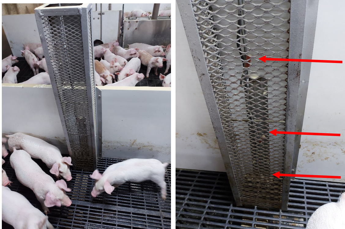
Figure 16 Dispositif à trois sondes pour mesurer la variation de la température
