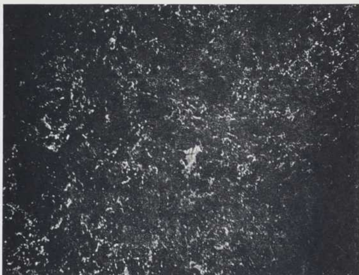
PLANCHE III A — Scorie de la coulée 2 —x100 La tache blanche au centre est de la matte. Espaces de magnétite dans l'échantillon pulvérisé.
