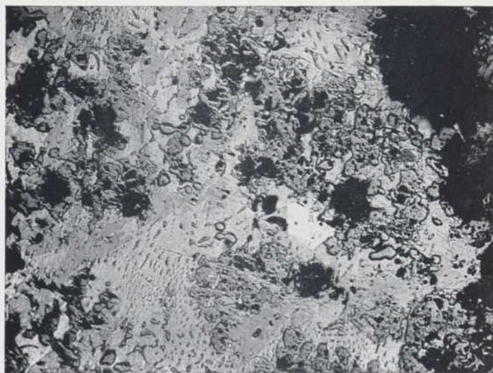
PLANCHE II B — 29.7 p. 100 de matte de cuivre —x100 Bornite avec un peu de magnétite. Les espaces noirs sont des vides.
