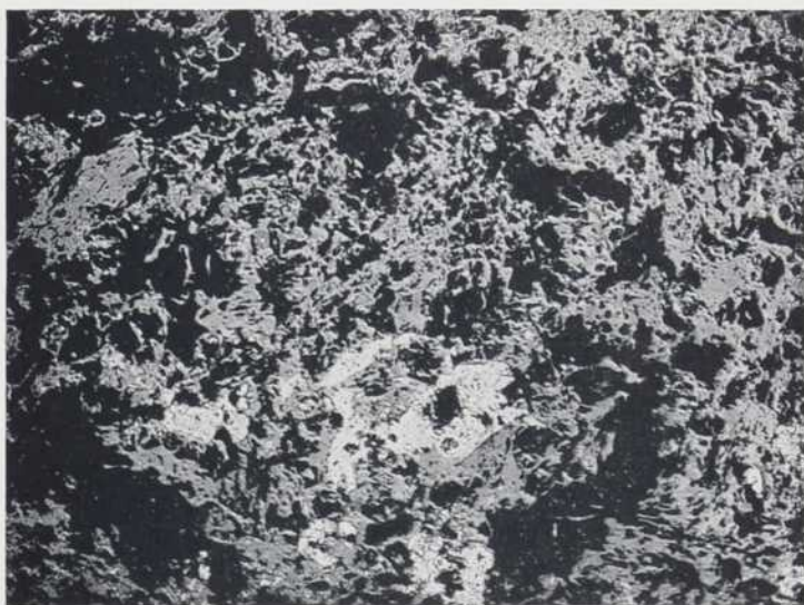
PLANCHE III B — Scorie de la coulée 4 —x100. Les espaces blancs sont de la matte.
