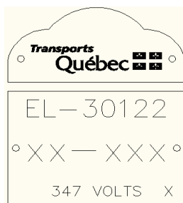
Figure 4.7-1 Plaque d'identification installée sur le terrain sur fût pour un système d'éclairage
