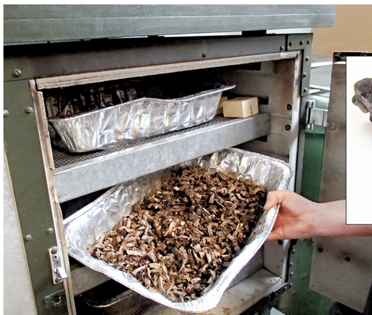
Four utilisé en laboratoire pour le prétraitement des pommes de terre (séchage), avant la carbonisation.
