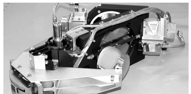
L'interféromètre qui sera construit pour la mission MATMOS sera basé sur celui-ci, qu'ABB Bomem a conçu pour l'Atmospheric Chemistry Experiment, en 2003. — PHOTO ABB BOMEM
