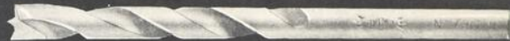
Fig. 29 — MÈCHE "FAMMAB" hélicoïdale avec mise rapportée en carbure de tungstène à pointe de centrage lisse et deux traçoirs, pour percer avec précision et sans éclats: le formica, l'arborite, les plastiques, les bois durs, les contreplaqués, les panneaux de particules, de fibres, etc. . .
