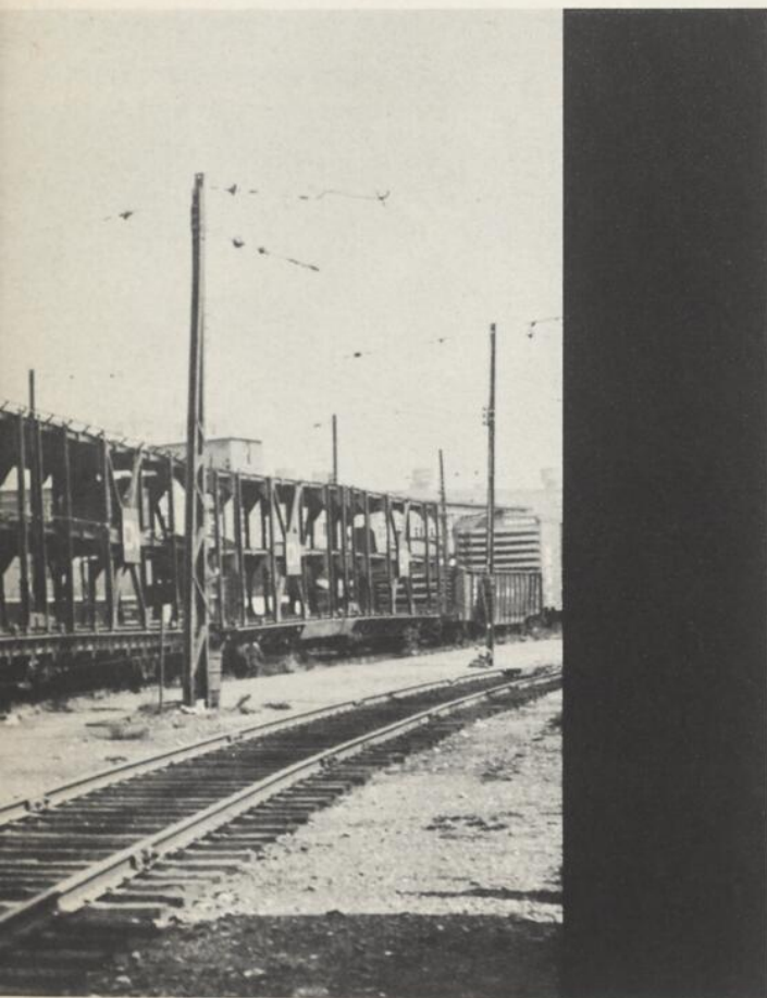
A gauche, la voiture d'essai du Canadien National attelée à deux wagons à trois étages pour le transport des automobiles, avant de procéder à des essais.
