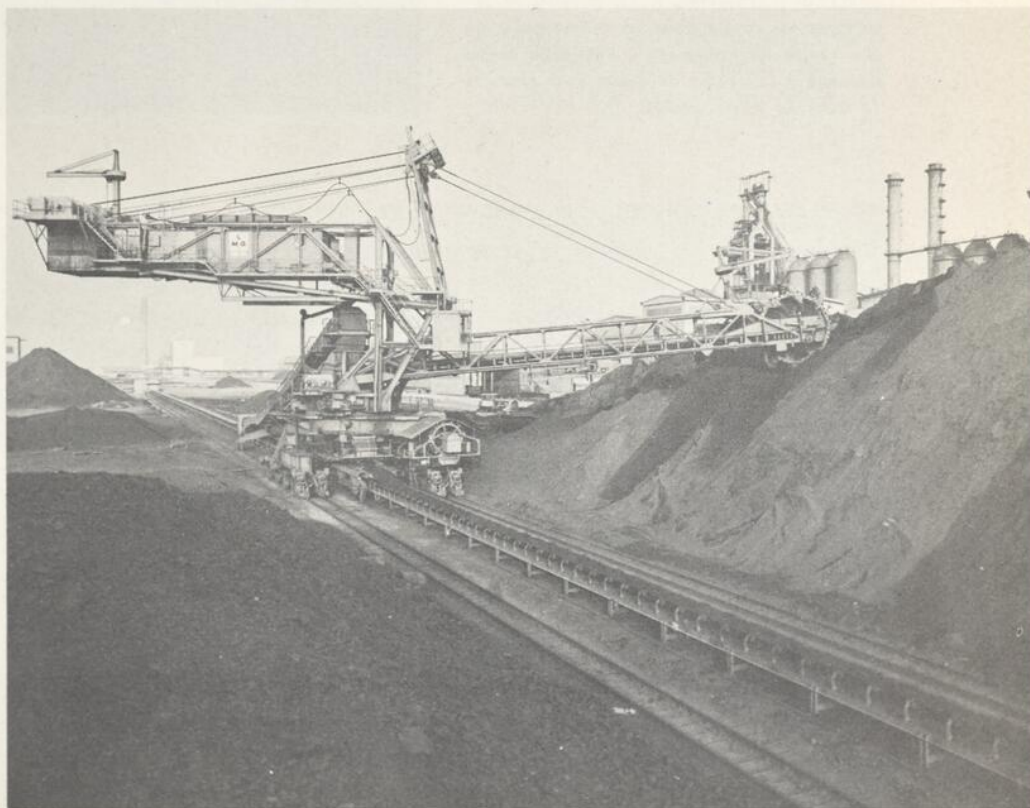
Une roue-pelle (à droite) récolte le minerai pour le déposer sur une bande transporteuse qui se rend jusqu'à l'usine.
