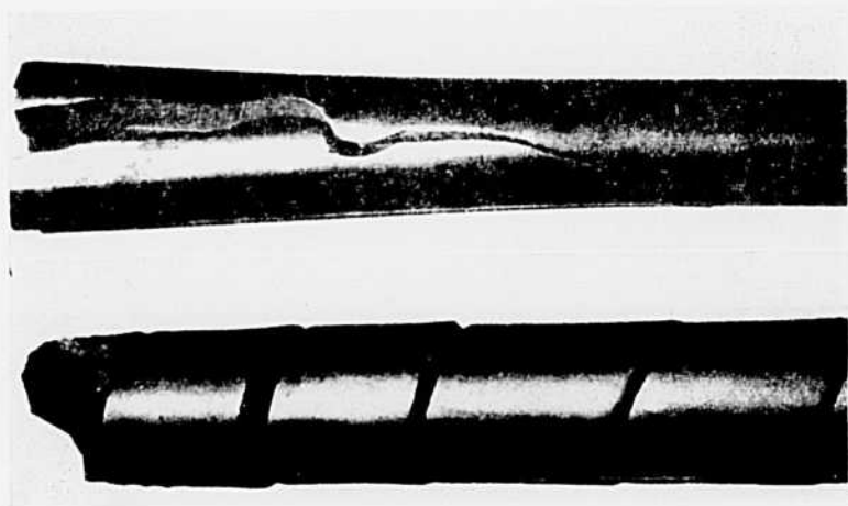
FIG. 1.— Deux barreaux en laiton cassés spontanément par tensions internes.
