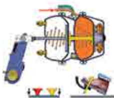
Alimentation en air du frein de stationnement
