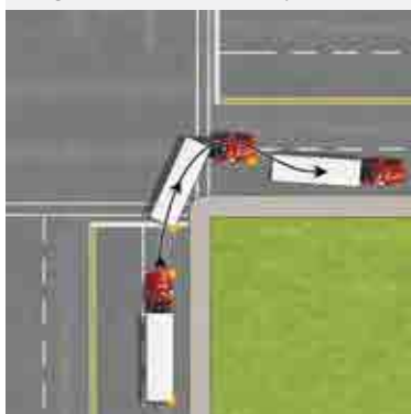
Virage à droite avec un tracteur semi-remorque
