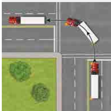
Virage à gauche avec un tracteur semi-remorque
