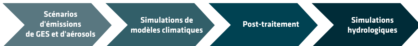
Figure 3 : Étapes de la modélisation hydroclimatique. Les scénarios d'émissions de gaz à effet de serre (GES) et d'aérosols définissent l'évolution des GES et des aérosols dans l'atmosphère pour le prochain siècle, ce qui affecte les conditions météorologiques et climatiques simulées par les modèles climatiques. Les simulations des modèles climatiques produisent des séries temporelles de variables telles que la température et la précipitation, qui sont post-traitées pour mieux correspondre aux observations statistiques du passé récent. Ces séries temporelles corrigées servent ensuite à piloter un modèle hydrologique déjà étalonné sur un bassin versant donné au moyen de séries temporelles de données météorologiques et de débits observés.
