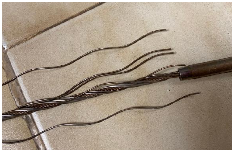
Brin de métal brisé sur l'étau intermédiaire tribord.
