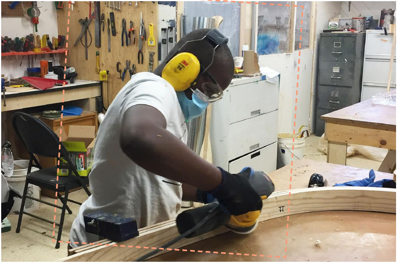
Espérance arrondit les angles des varangues pour que la toile du bateau ne s'y use pas prématurément.
