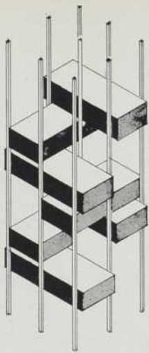
Construction en spirale des éléments.
