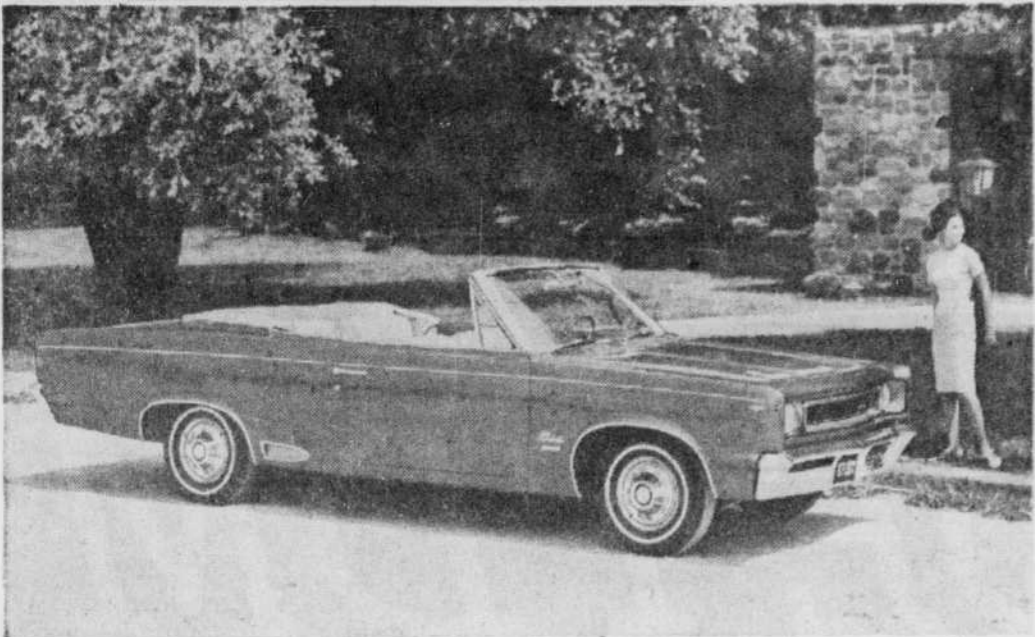
Un mécanisme unique pour la toiture de la décapotable, qui se replie derrière le siège arrière, allouant l'espace nécessaire pour assurer six passagers dans la décapotable Rebel SST de 1967. Antérieurement, le siège arrière ne procurait qu'un espace suffisant pour deux personnes, parce que le mécanisme de la toiture s'enfonçait dans des puits logés de chaque côté du siège arrière. La décapotable Rebel SST a une lunette arrière non flexible, laquelle permet d'élever et de rabaisser la capote sans avoir à défaire et refaire la fermeture éclair. Toutes les capotes des décapotables American Motors fonctionnent au moyen de la force motrice, procurée comme équipement standard.
