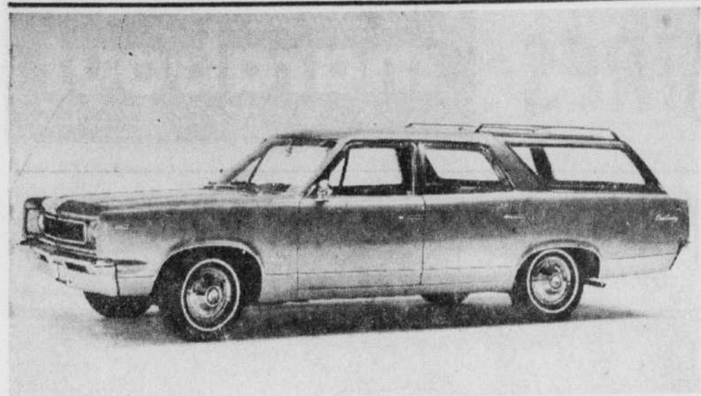
Le volume du cargo arrière a été augmenté, presque de 25 pour cent dans les wagonnettes 1967 des "Rebel" toutes neuves d'American Motors. Des améliorations substantielles ont également pris place quant aux dimensions de l'ouverture à la porte de rabat, lesquelles sont presque deux pouces de plus en largeur et trois pouces de plus en hauteur, comparativement aux wagonnettes Classic de 1966. Les portes à rabats régulières avec gonds horizontaux ou gonds verticaux sont facultatives et sont offertes sans frais supplémentaires sur les wagonnettes Rebel à deux sièges. La Rebel 770 à trois sièges caractérise une fenêtre électrique à la porte de rabat comme équipement standard. Un porte-bagages au pavillon est standard sur toutes les wagonnettes Rebel.
