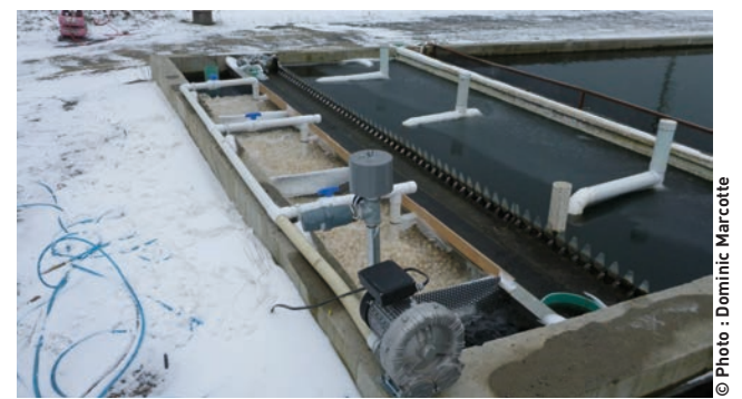
Biofiltre utilisé dans l'entreprise Pisciculture Gilbert inc.
