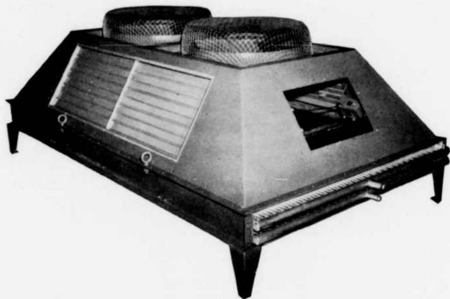
Condenseurs "Buffalo" refroidis à l'air. Expédiés de l'usine comme ensembles montés. Capacité de 7½ à 100 tonnes pour une température de condensation de 120°, avec 40° à la succion et 100° d'ambiante.
