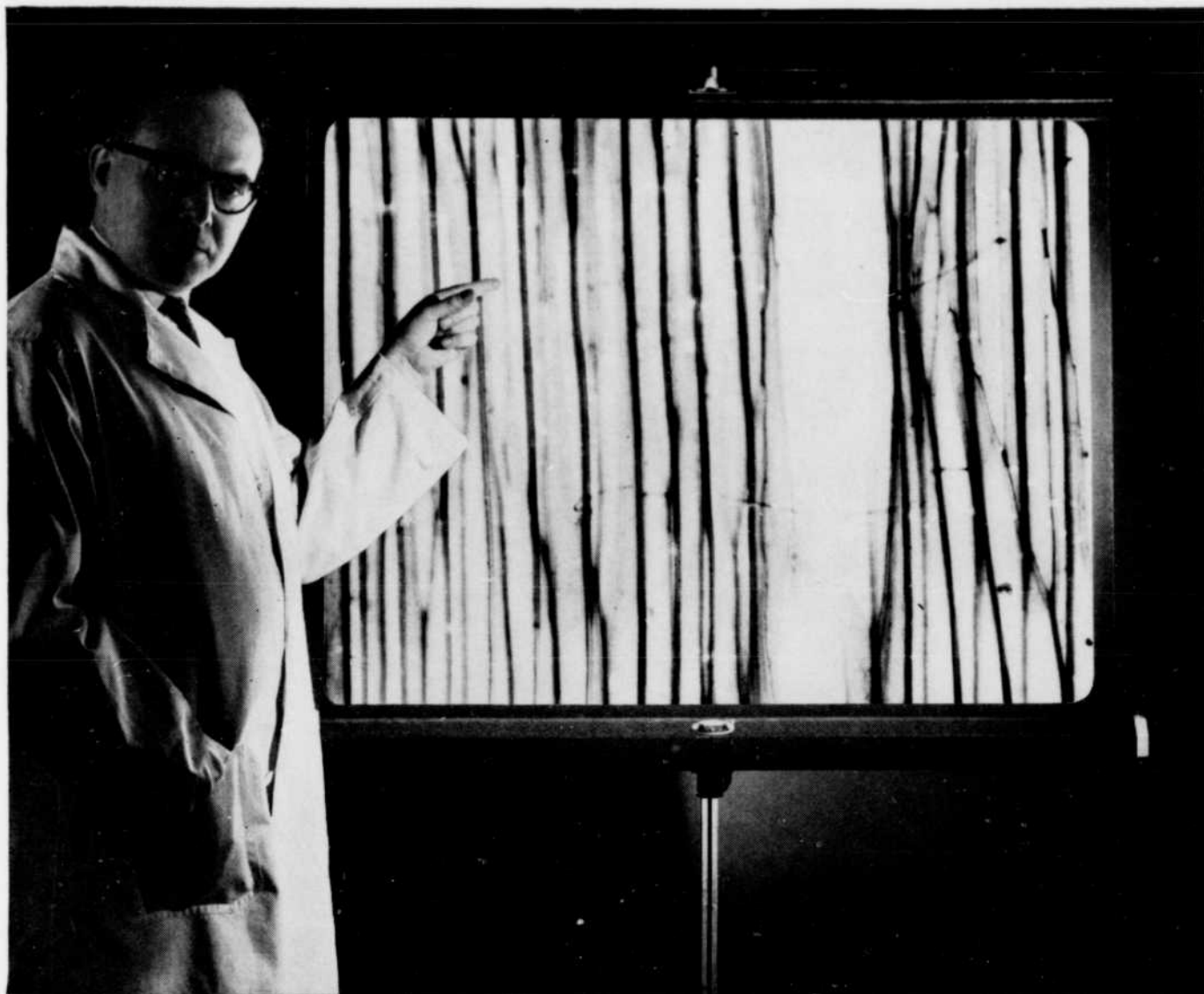
Photomicrographie communiquée par le Service de recherches sur les produits forestiers du ministère des Forêts, à Ottawa, montrant les filaments creux d'aspect inoffensif appelés hyphes (dont la masse forme le mycélium) qui causent la pourriture du bois. Ils représentent un type de végétation d'ordre très inférieur transporté par l'air.
