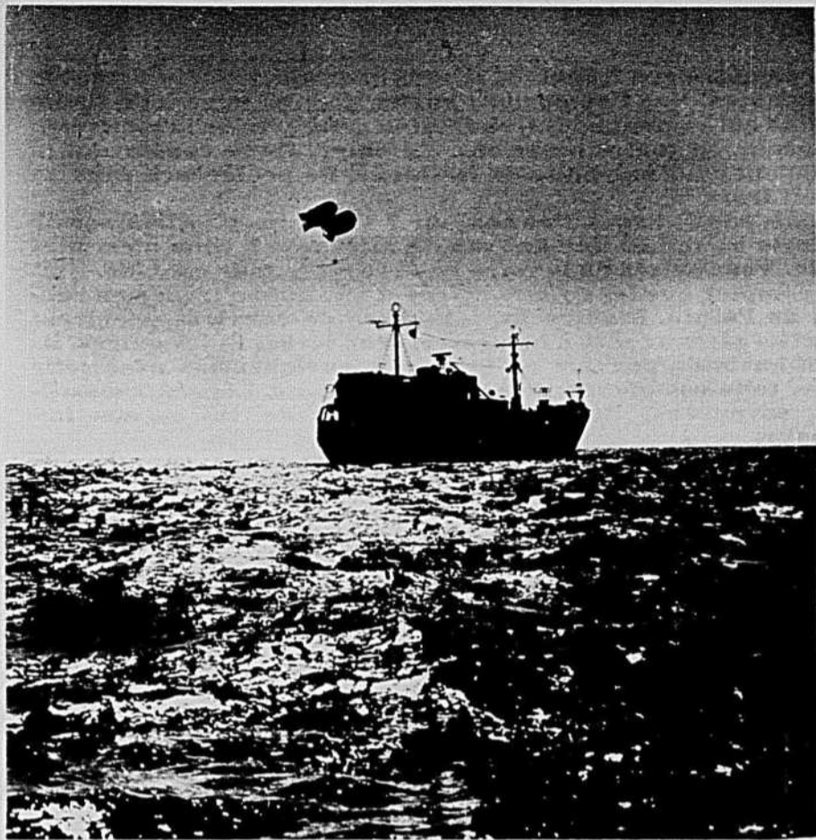
C'est par un ballon cerf-volant, captif à mille pieds dans les airs, que l'on obtient les indications météorologiques relatives à la température, à l'humidité et aux vents.
