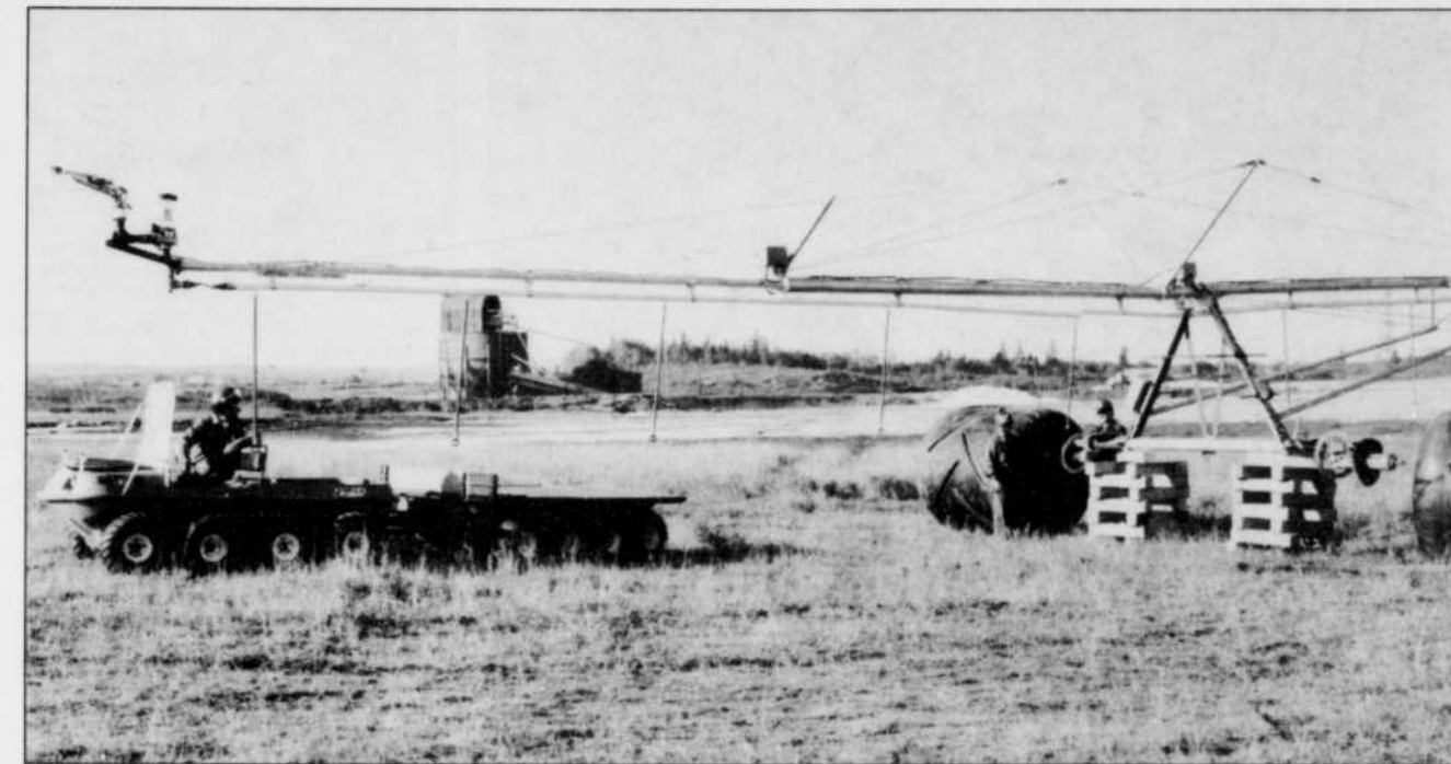
Danys Morin travaille constamment au développement de nouveaux systèmes pour le contrôle des poussières. Les technologies utilisées ici consistent d'abord à attacher l'un à l'autre deux véhicules. Ces derniers peuvent fonctionner dans plusieurs conditions difficiles, comme par exemple se déplacer dans la boue épaisse et dans l'eau. Puis, à l'arrière, on retrouve un système d'arrosage autonome de 400 pieds de longueur, appelé arrosoir mobile, qui permet de mouiller les surfaces dans toutes les conditions possibles et inimaginables.
