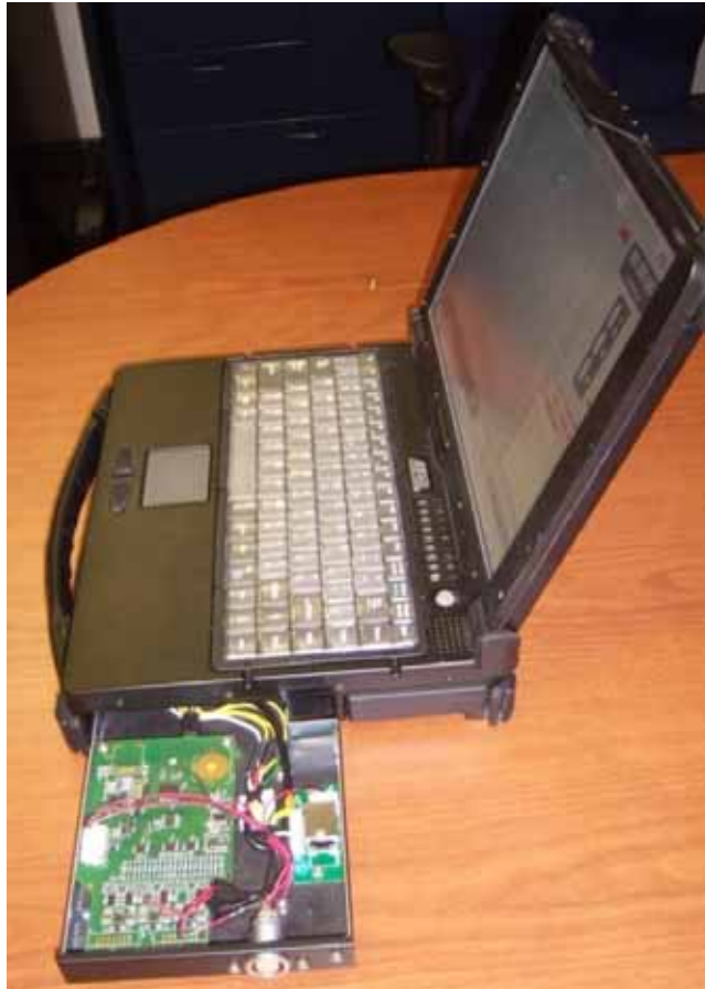
Figure 27 – Compartiment de l'ordinateur avec la carte SR-MK3 et la carte de conditionnement de signaux et d'alimentation ICP
