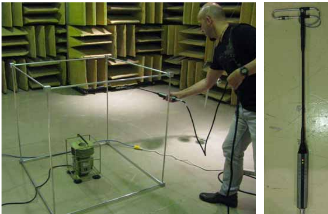
Figure 43 – Mesure de la puissance acoustique d'une source de référence à l'aide d'une sonde intensimétrique Brüel&Kjaer (gauche) photo de la sonde intensimétrique Brüel&Kjaer (droite)
