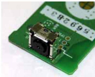
Figure A3 – Nintendo TM - PixArt Mot Sensor
