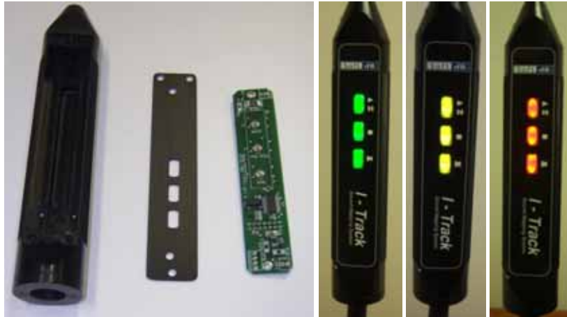
Figure 24 – Poignée de la sonde avec son circuit de télécommande et boutons de contrôle rétro éclairés
