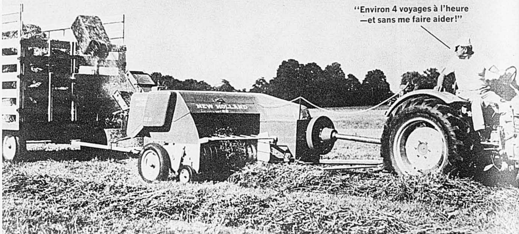
La presse à foin Super Hayliner 69 de 14 x 18 de New Holland avec chargement automatique sur le chariot, alimentation continue et commandes à portée du siège du tracteur.
