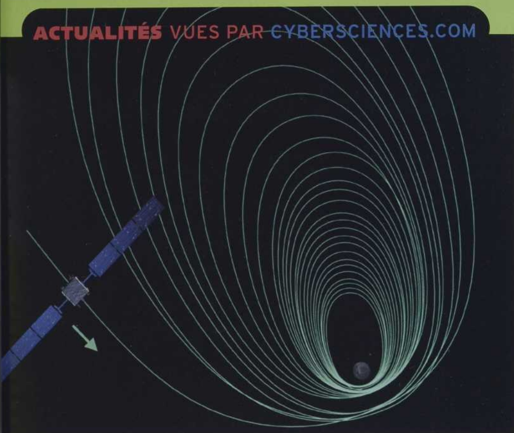
Le moteur ionique mènera la sonde SMART-1 jusqu'à la Lune. Elle sera alors capturée par le champ gravitationnel lunaire.
