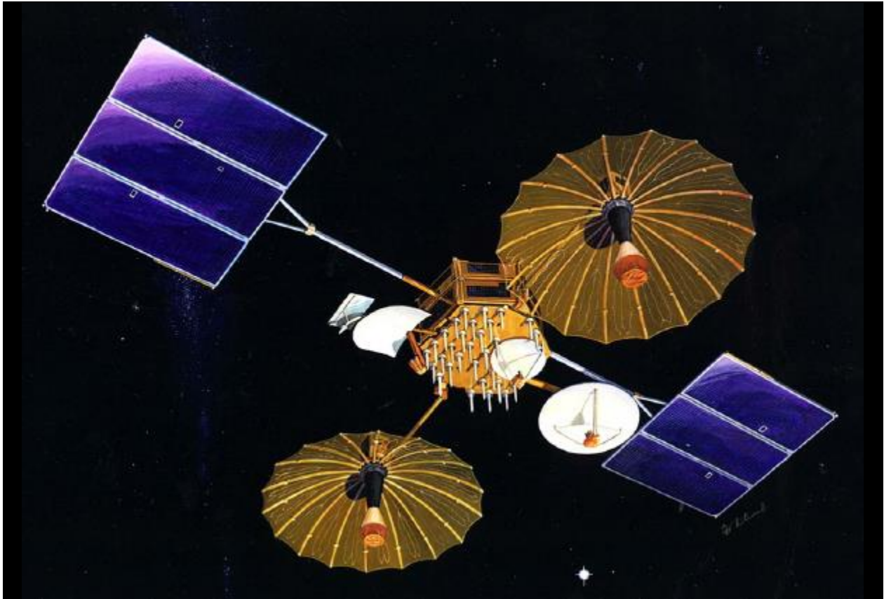
Anatomie d'un satellite de communication; ici un TDRS de la NASA doté d'antennes de diffusion (rondes) et de panneaux solaires (bleus) qui génèrent l'électricité de bord.
