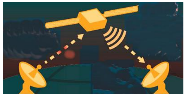
Principe d'un satellite de communication, qui relaie les signaux d'une antenne à l'autre.
