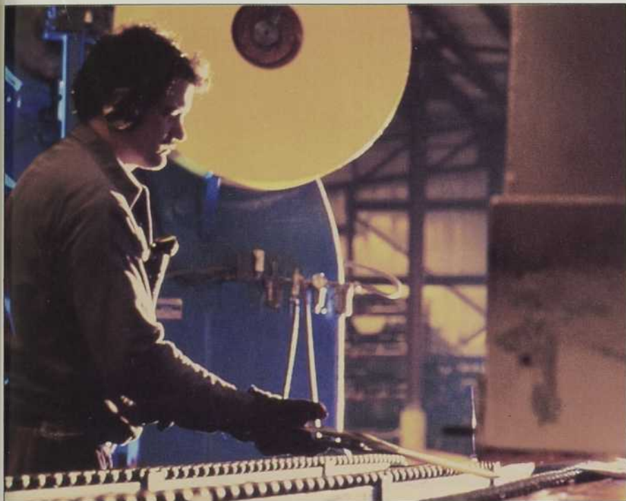
Four de chauffage rapide des métaux fabriqué et utilisé chez M.T.C. de Chambly, entreprise qui produit des ressorts à lames pour véhicules lourds. L'utilisation du gaz naturel permet une utilisation rapide du four, à de très hautes températures.
