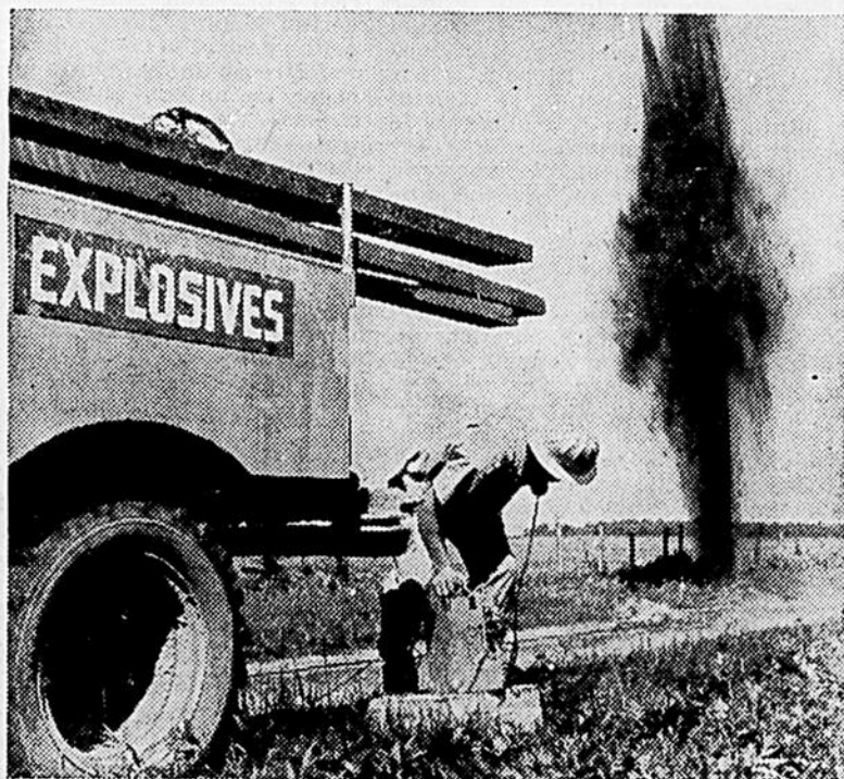
Une équipe de prospection sismique de l'Imperial Oil effectuait des recherches aux environs de St-Grégoire, à sept milles à l'est de Nicolet, l'été dernier. Ses études des formations rocheuses susceptibles de contenir du pétrole sont l'objet d'un article du dernier numéro de "La Revue Imperial Oil". L'un des techniciens déclenche une petite explosion qui lance des ondes de vibration jusque dans les profondeurs des couches souterraines.
