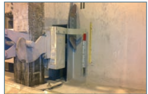
Des nouvelles règles de mesure ont été ajoutées à la superstructure ainsi que sur les cadres anodiques.
