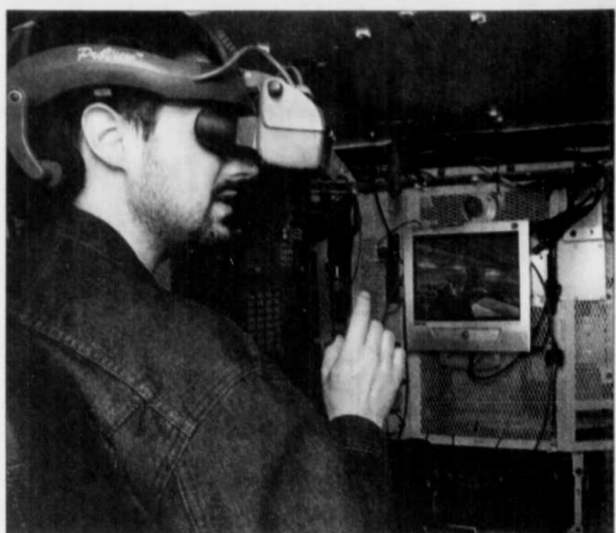
Notre journaliste a coiffé le visiocasque du véhicule blindé léger développé à Valcartier, qui permet une vue à 360 degrés.
